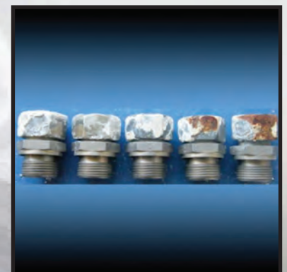
Salzsprühnebeltest nach 780 h
