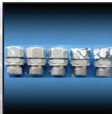
Salzsprühnebeltest nach 190 h
