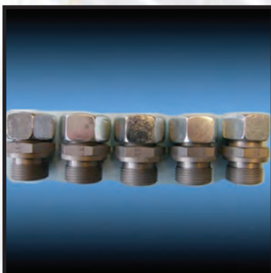
Mutter: Zink Stutzen: Zink-Nickel
